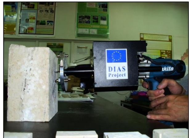
Figure 7: Resistance drilling in action. Photo: Laboratorio de Petrofísica del Instituto de Geociencias IGEO (CSIC-UCM).
